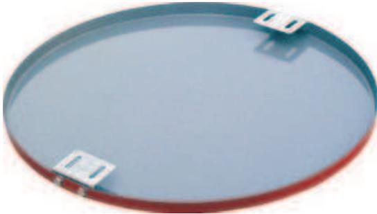
Señales homologadas fabricadas en chapa acero galvanizado o aluminio estampadas y troqueladas. Diferentes dimensiones en base a las normas 8.1-IC y 8.3-IC para obras. Espesor de la chapa 1,8 a 2 mm. Anclajes incluidos. Tratamiento base - pintura al horno con pintura Epoxi. Vinilos - Adhesivos reflexivos o de base acrílica permanente. Duración del vinilo - 5/7/10 años. Señales con marcado CE.
