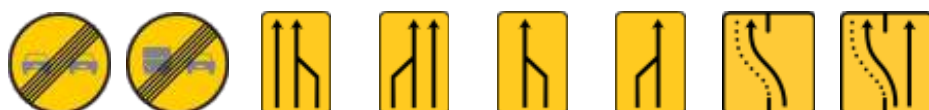
TR-502 Fin de prohibición de adelantamiento TR-503 Fin de prohibición de adelantamiento para camiones TS-52 Reducción de un carril por la derecha TS-53 Reducción de un carril por la izquierda TS-54 Reducción de un carril por la derecha TS-55 Reducción de un carril por la izquierda TS-60 Desvío de un carril por la calzada opuesta TS-61 Desvío de un carril por la calzada opuesta, manteniendo otro por la de obras
