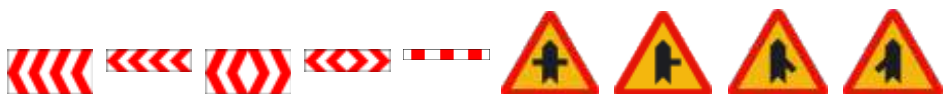
TB-1 Panel direccional alto TB-2 Panel direccional estrecho TB-3 Panel doble direccional alto TB-4 Panel doble direccional TB-5 Panel de zona excluida al tráfico
