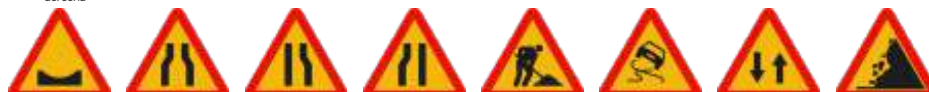
TP-15B Badén TP-17 Estrechamiento de Calzada por Obras TP-17A Estrechamiento de Calzada por la Derecha TP-17B Estrechamiento de Calzada por la Izquierda TP-18 Obras TP-19 Pavimento deslizante TP-25 Circulación en los dos sentidos TP-26 Desprendimiento
