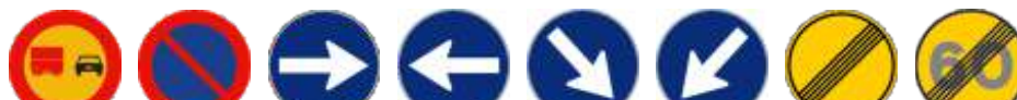
TR-306 Adelantamiento prohibido a camiones TR-308 Estacionamiento prohibido TR-400A Sentido obligatorio TR-400B Sentido obligatorio TR-401A Paso obligatorio TR-401B Paso obligatorio TR-500 Fin de prohibiciones TR-501 Fin de la limitación de velocidad
